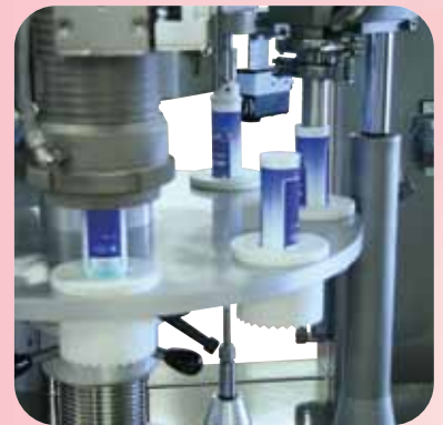
• Sistema di chiusura ad aria calda per tubetti in plastica e laminati
