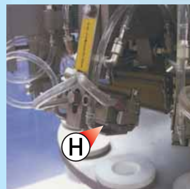
SISTEMA DI CHIUSURA A PINZE CALDE PER TUBETTI IN POLITENE E LAMINATO HOT JAWS SYSTEM FOR PLASTIC AND LAMINATED TUBES
