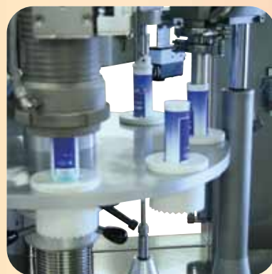
• Sistema di chiusura ad aria calda per tubetti in plastica e laminati
